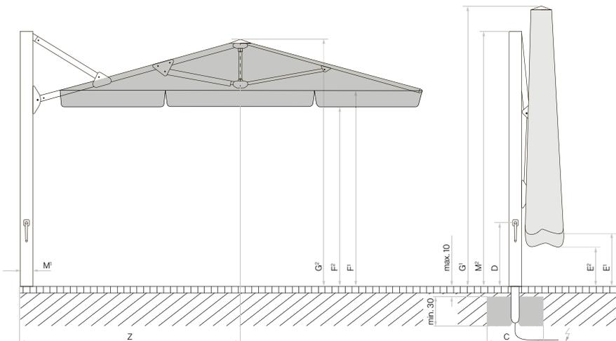
Looser Deckbelag max. 10 cm, Betondicke min. 30 cm (Frosttiefe beachten), Wasserabfluss gewährleistet, Zuleitung elektrisch.
