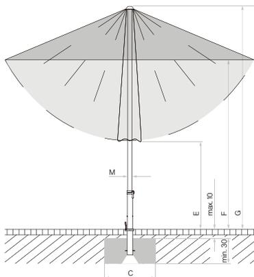
Loser Deckbelag max. 10 cm, Betondicke min. 30 cm (Frosttiefe beachten), Wasserabfluss gewährleisten.
