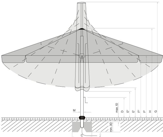
Looser Deckbelag max. 10 cm, Betondicke min. 30 cm (Frosttiefe beachten), Wasserabfluss gewährleisten, Zuleitung elektrisch.
