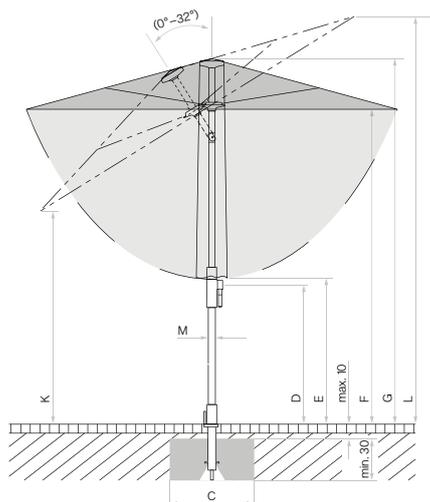
Looser Deckbelag max. 10 cm, Betondicke min. 30 cm (Frosttiefe beachten), Wasserabfluss gewährleisten.
